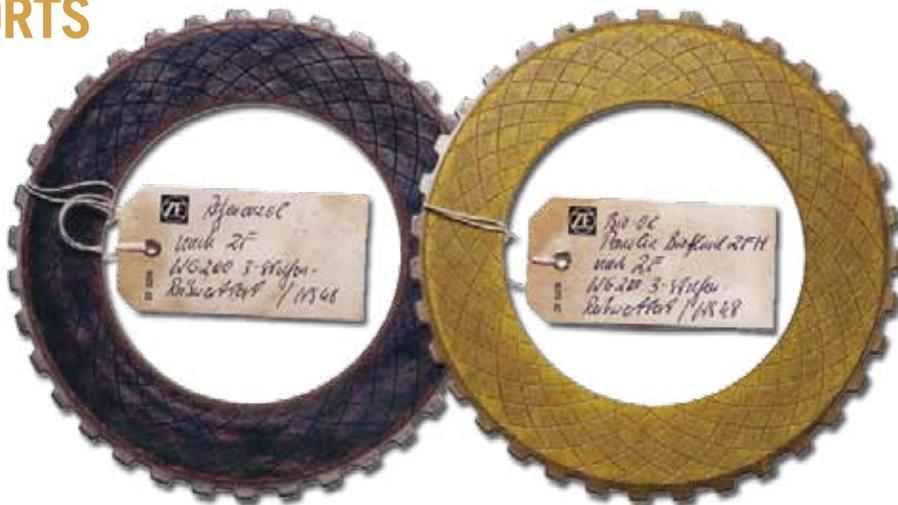
Comparaison de lamelles selon l'essai WG 200 de coefficient de friction en trois étapes (à gauche : l'huile de référence; à droite : le BIOFLUIDE PANOLIN ZFH)
